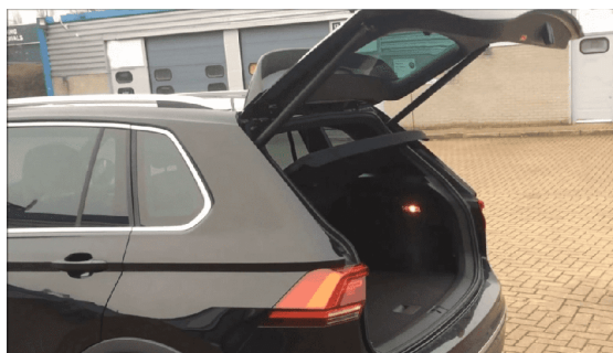
(a) Automaticky otevírané páté dveře u automobilu Volkswagen Tiguan, převzato z [3]
