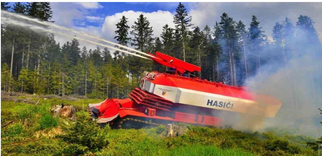
Obrázek 5 - Požární tank SPOT 55 (Disponuje cisternou na 11 000 l požární vody a 2000 l pěnidla, dosah lafet 60 m, zdroj: archiv ZÚ HZS ČR Hlučín)
