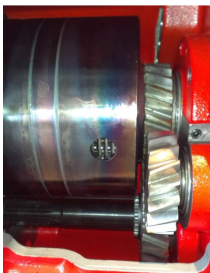
Obr. 5 Lamelová spojka pojezdová a reverzační [vlastní foto]
