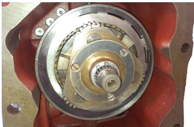
Obr. 2 Spojková skříň s odkrytým násobičem [vlastní foto]
