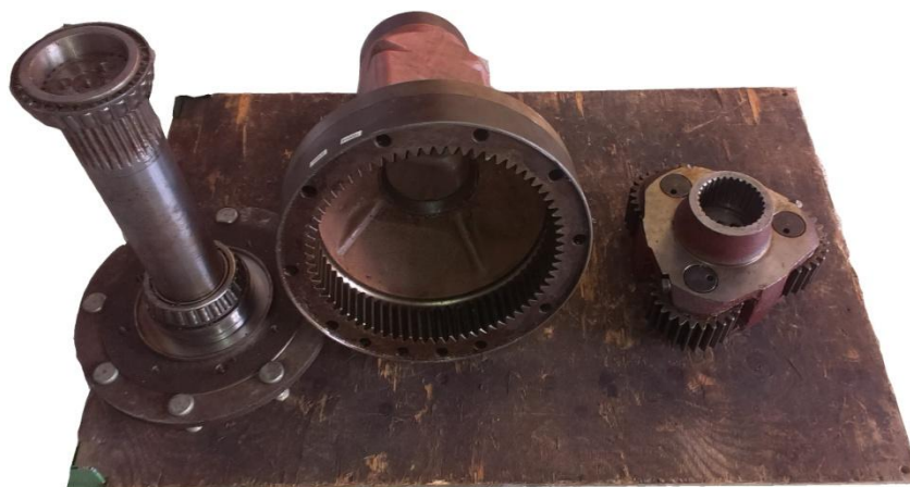
Obr. 12 Rozložené komponenty zadní nápravy [vlastní foto]
