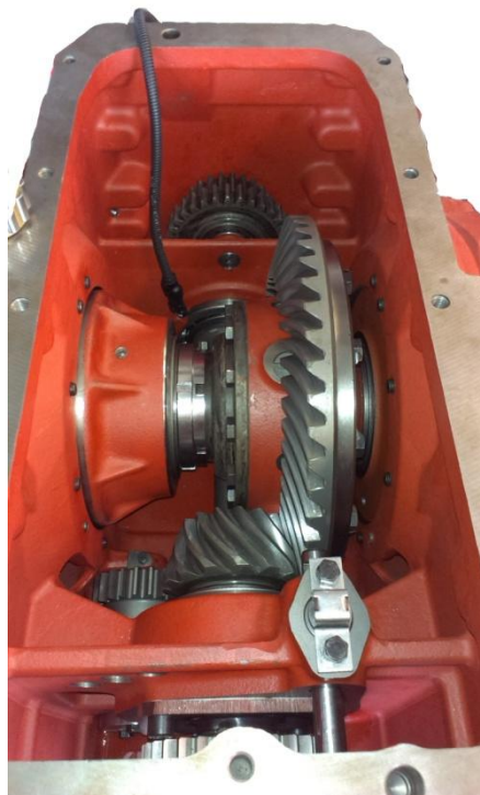
Obr. 10 Skříň stálého převodu s diferenciálem a redukční převodovkou [vlastní foto]
