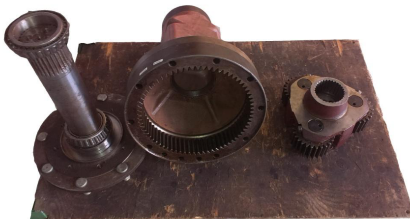
Obr. 12 Rozložené komponenty zadní nápravy [vlastní foto]
