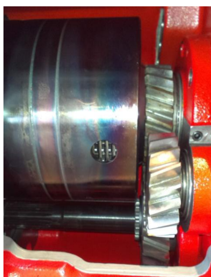
Obr. 5 Lamelová spojka pojezdová a reverzační [vlastní foto]
