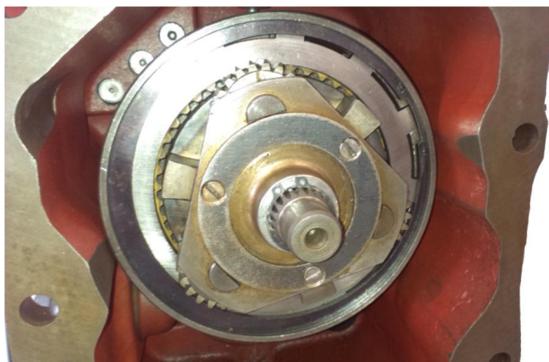
Obr. 2 Spojková skříň s odkrytým násobičem [vlastní foto]
