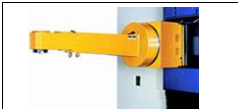
Obr. 18 Pravoúhlá frézovací hlava IFVW 112 [20]
