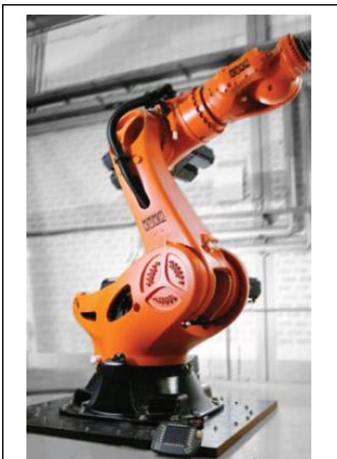
Obr. 26 Robot pro automatickou výměnu nástrojů KUKA [2]
