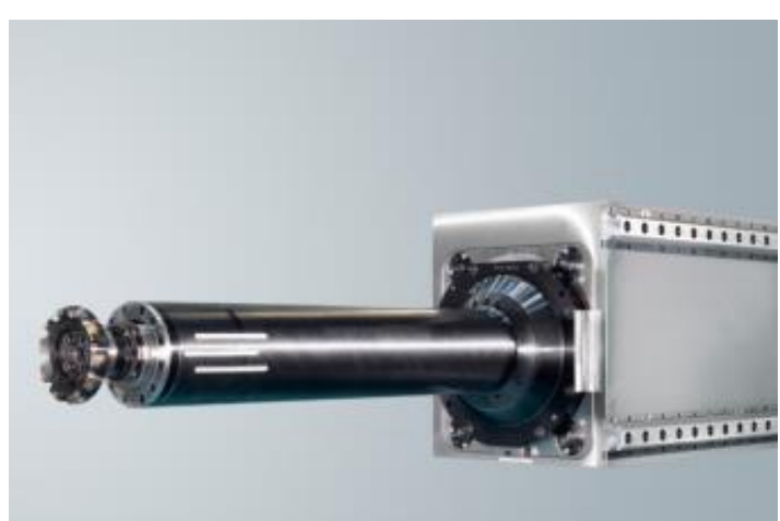
Obr. 7 Pevná horizontální hlava SOLARUCE [11]
