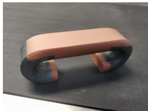
Obr. 7 C-profil natřen látkou Condursal.
