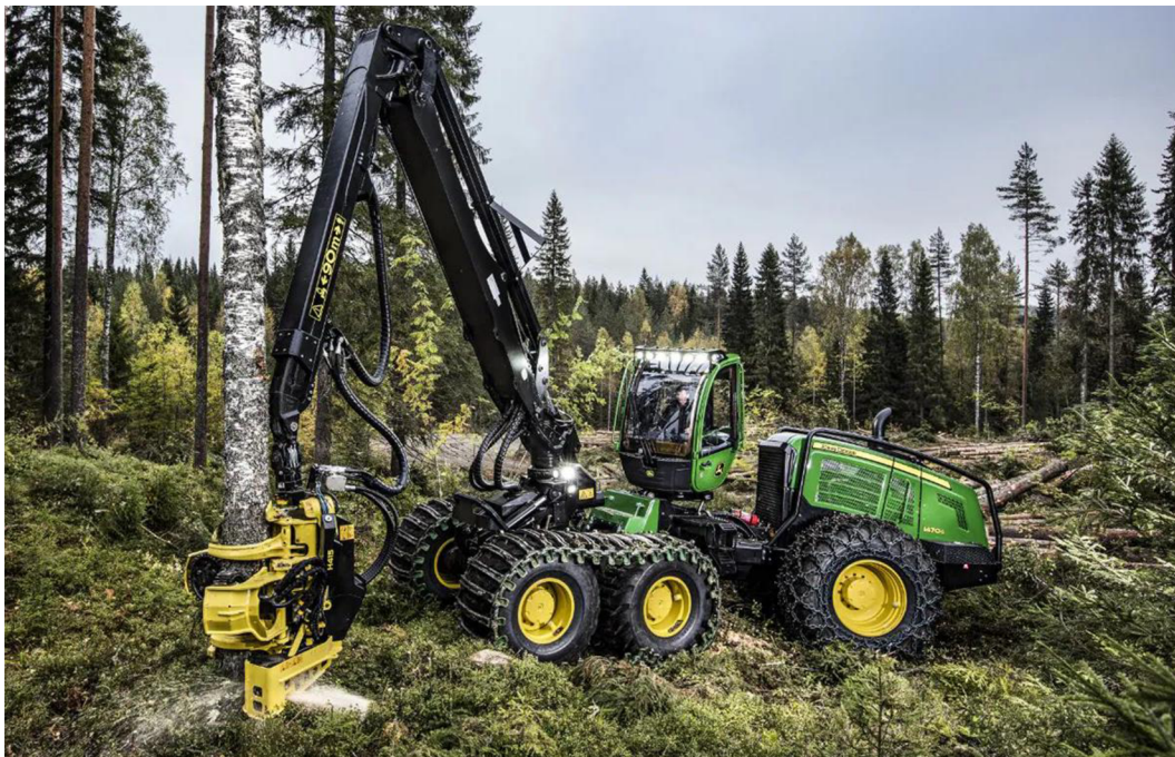
Obr. 1 Kolový harvestor s trakčními pásy. [29]
