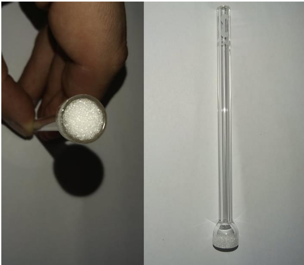
Obrázek 5 difuzor v pravo celý pohled v levo pohled na keramickou vložku difizoru
