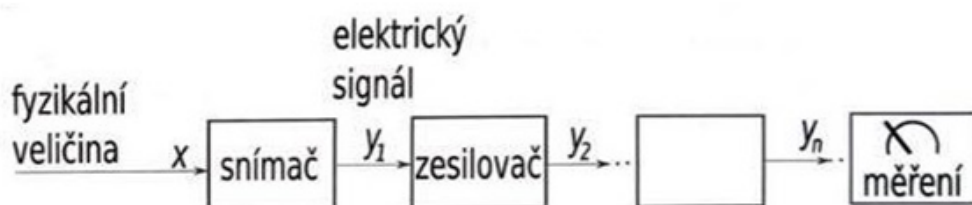
Obr. 1.1: Usporiadanie meracieho reťazca v klasickom senzore [1]
