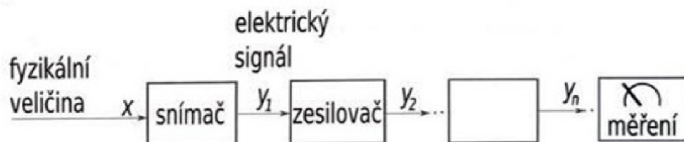
Obr. 1.1: Usporiadanie meracieho reťazca v klasickom senzore [1]
