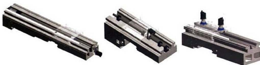
Obr. 2.2: Príklad prevedenia náhonu lineárnej posuvnej sústavy [2]
