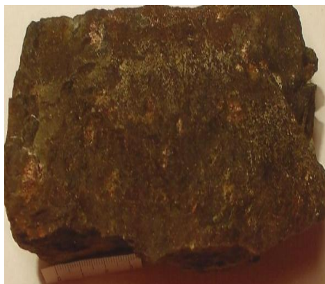
Obr. 25. Serpentinit zelenočerné barvy se zrny granátu, čerstvý, vzorek M2
