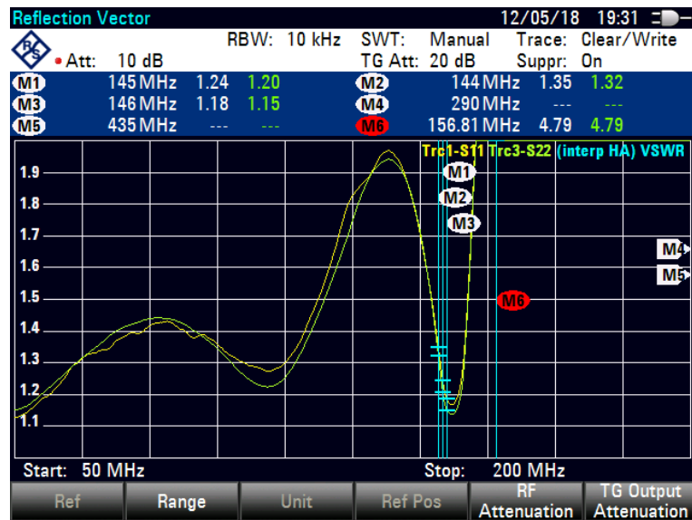
Obrázek 44 PSV filtru v propustném pásmu se šikmou orientací cívek vzhledem k hraně DPS
