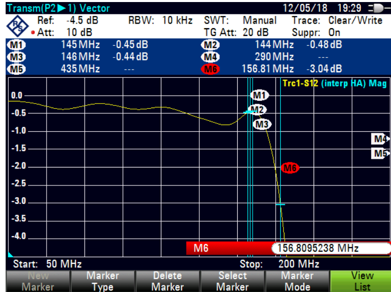
Obrázek 43 Přenos filtru v propustném pásmu se šikmou orientací cívek vzhledem k hraně DPS
