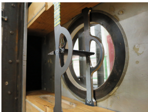
Obrázek 1: Uchycení modelu křídla v měřicí sekci aerodynamického tunelu
