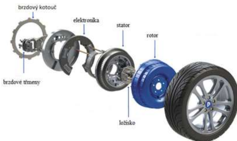
Obrázek 1 Uložení elektromotoru v kole vozidla
