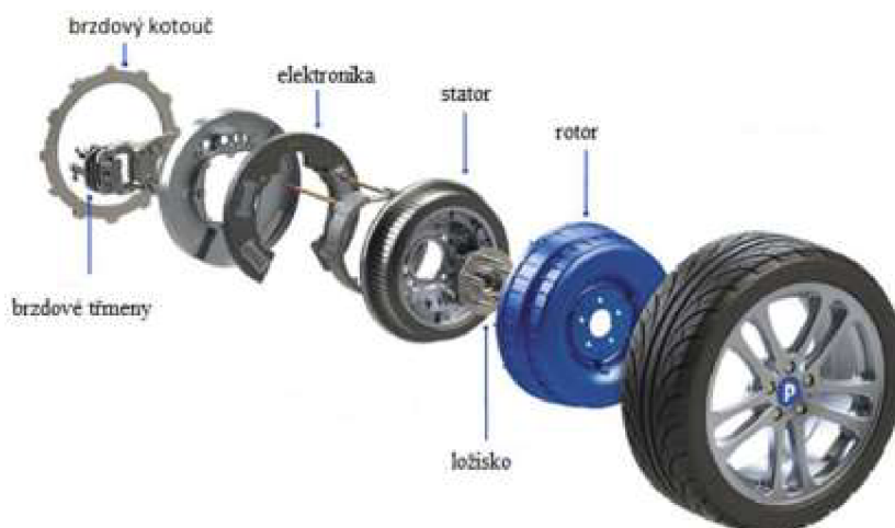
Obrázek 1 Uložení elektromotoru v kole vozidla
