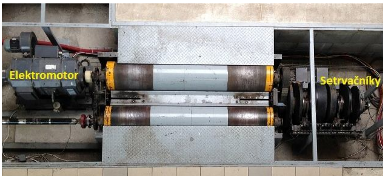
Obr. 16: Válcová zkušebna (pohled shora).
