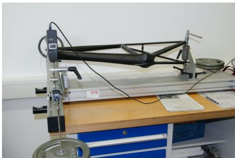
Obr. 18 Test tuhosti řízení
