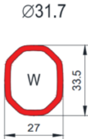
Obr. 10 Průřez horní rámovou trubkou [8]
