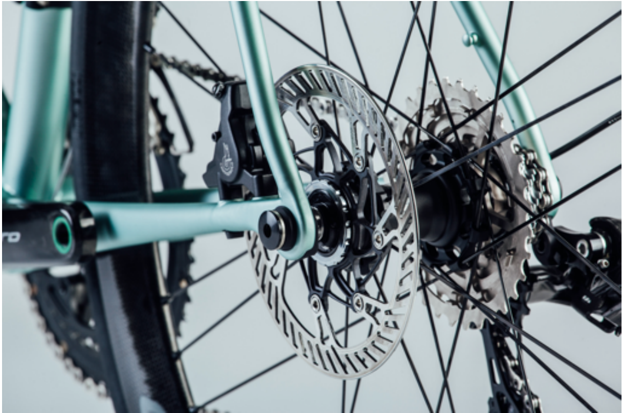
Obr. 17 Detail na patky rámu [13]
