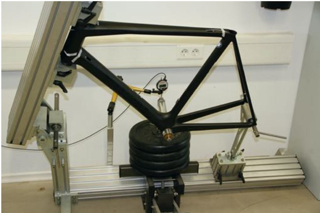
Obr. 19 Test tuhosti středu
