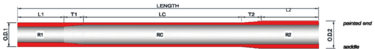
Obr. 12 Výkres sedlové trubky [8]
