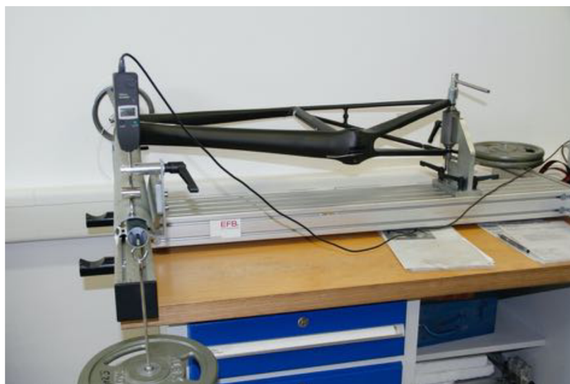
Obr. 18 Test tuhosti řízení
