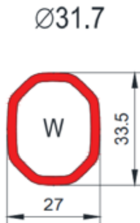
Obr. 10 Průřez horní rámovou trubkou [8]
