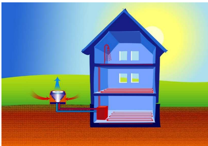
Obr. 16: Schéma: tepelné čerpadlo – vzduch/voda [22]
