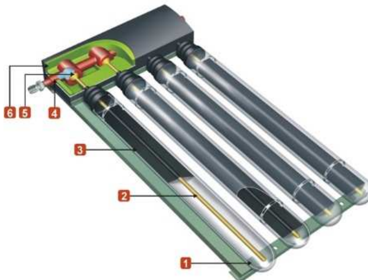
Obr. 23: Konštrukcia trubicového kolektora „Heat Pipe“
