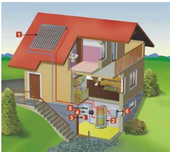
Obr. 21: Solárny systém rodinného domu
