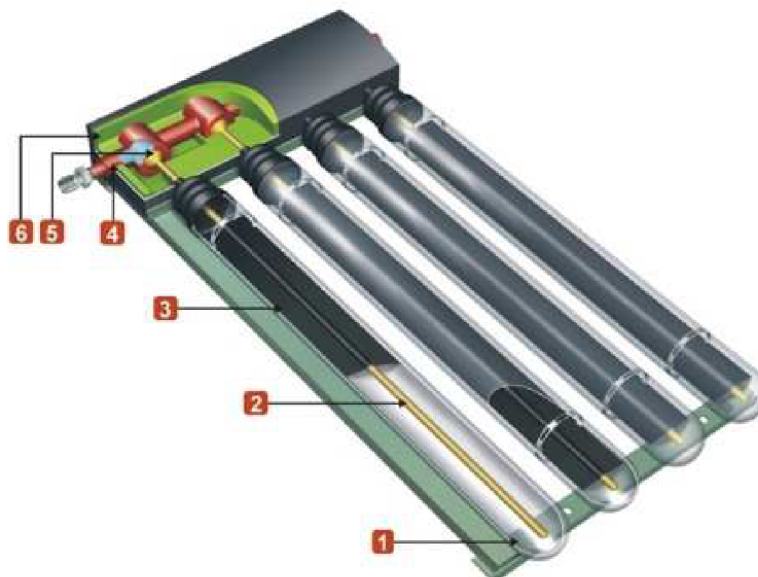
Obr. 23: Konštrukcia trubicového kolektora „Heat Pipe“
