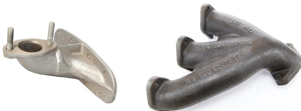
Obr. 22 Sacie a výfukové potrubie [19] [20]
