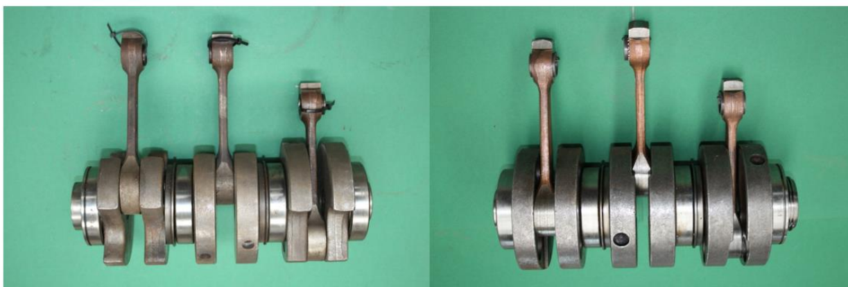
Obr. 9 Porovnanie variantov kľukových hriadel'ov – vľavo 33 kW, vpravo 37 kW [12] [13]
