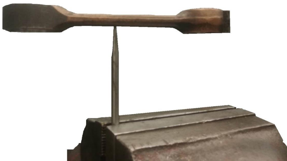
Obr. 17 Skutočná poloha ťažiska ojnice
