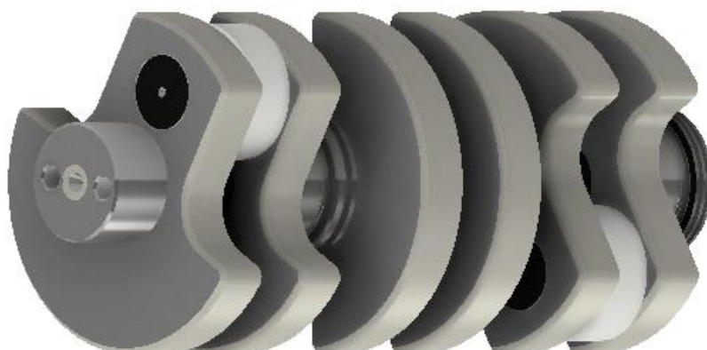
Obr. 35 Rotujúce podiely ojníc nahradené ekvivalentnými krúžkami
