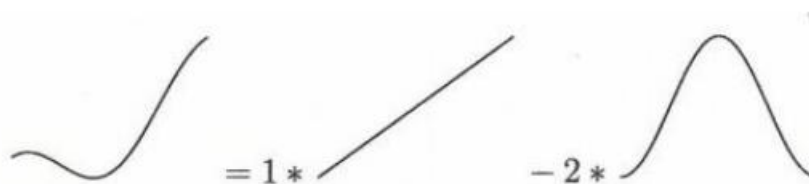
Obr. 43 Deformácia a jej aproximácia súčtom tvarov telesa [33]
