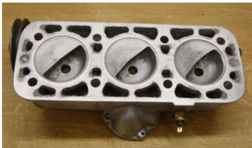
Obr. 13 Hlava valcov s ľadvinovitým spaľovacím priestorom [18]
