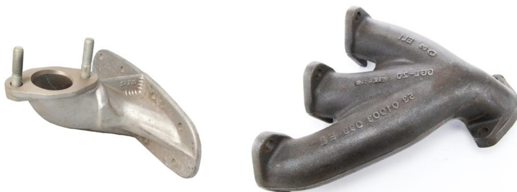
Obr. 22 Sacie a výfukové potrubie [19] [20]
