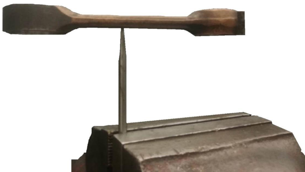
Obr. 17 Skutočná poloha ťažiska ojnice
