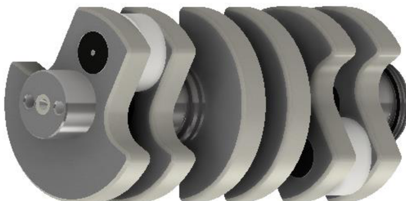
Obr. 35 Rotujúce podiely ojníc nahradené ekvivalentnými krúžkami
