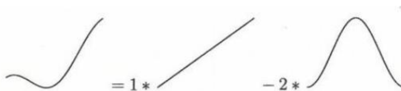
Obr. 43 Deformácia a jej aproximácia súčtom tvarov telesa [33]
