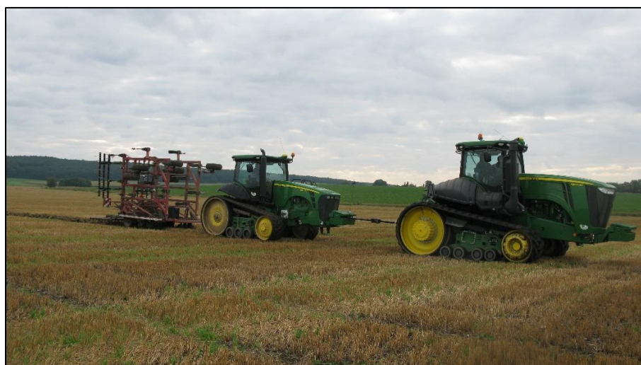
Obrázek 5 Souprava pro měření tahového odporu v roce 2017
