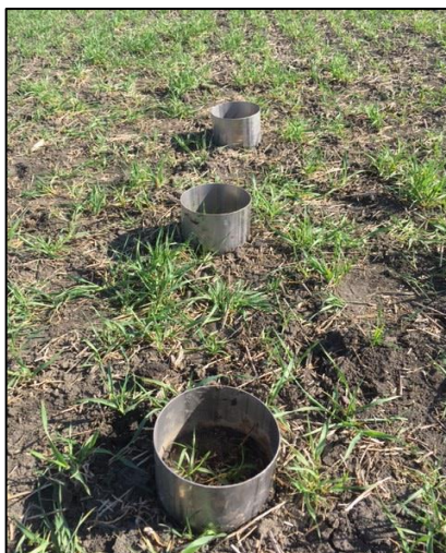
Obrázek 6 Válce pro měření infiltrace vody
