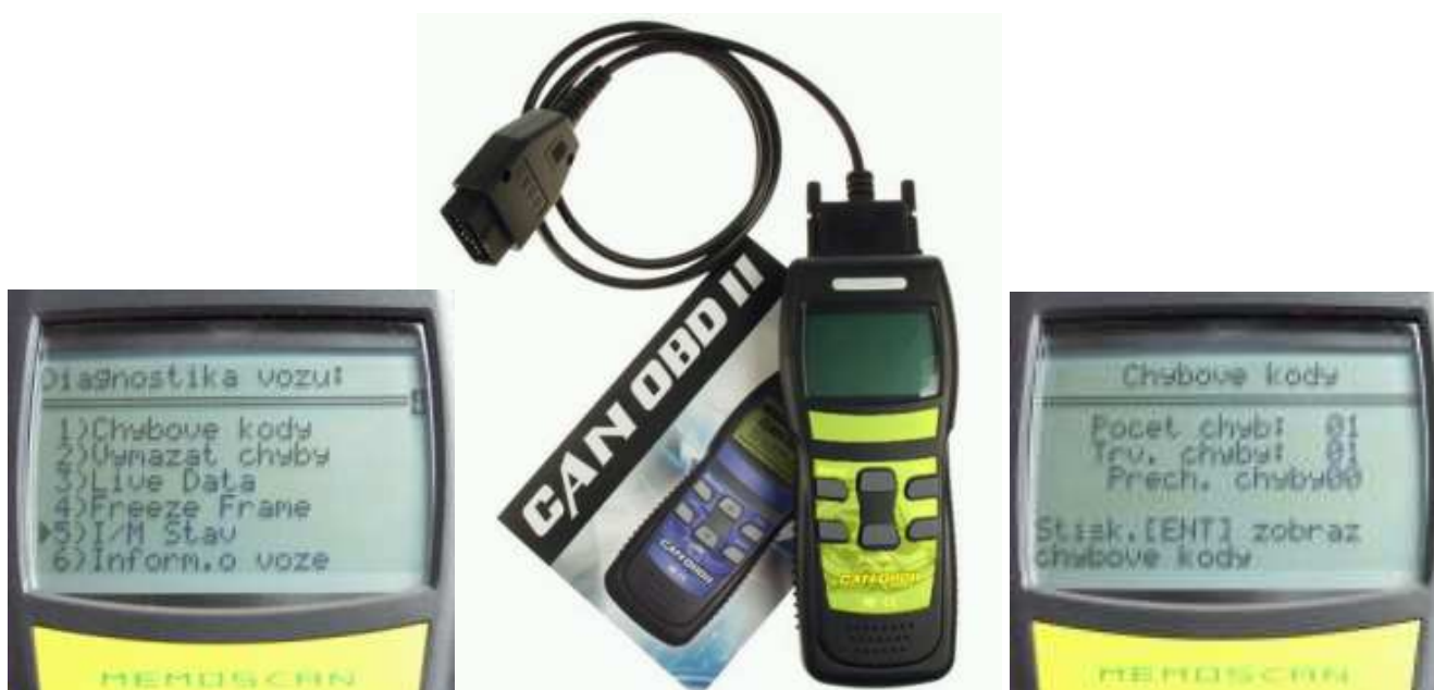
Obr. 3.4 – Autoscanner U581 CZ
