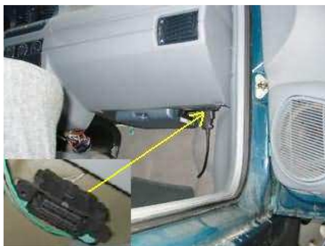
Obr. 4.15 – Umístění diagnostické zástrčky Škoda Felicia Zdroj: [14]
