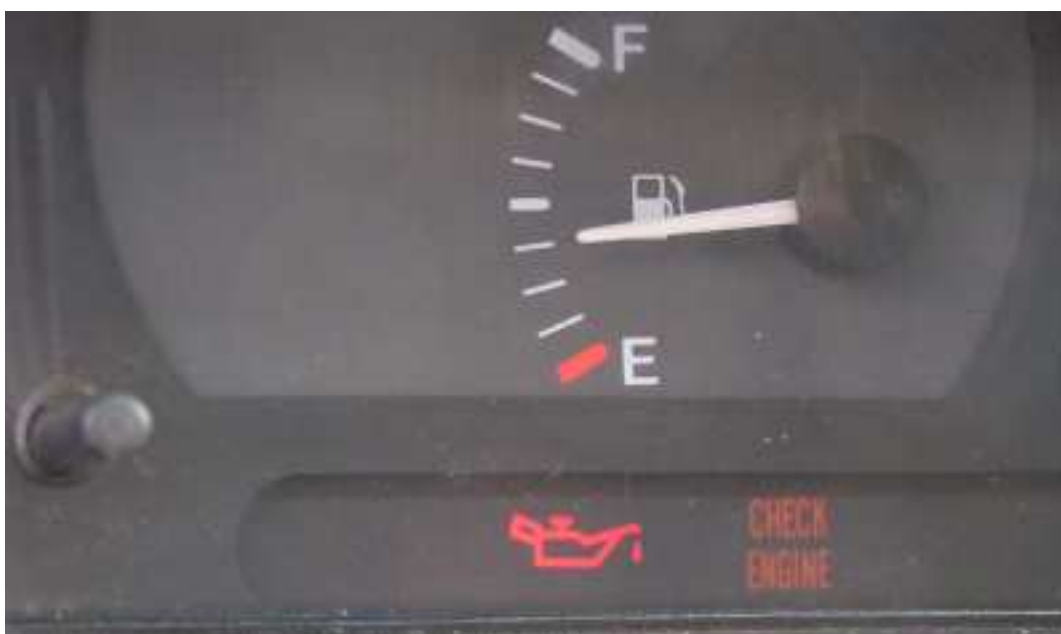
Obr. 4.2 – Kontrolka MIL (provedení CHECK ENGINE)
