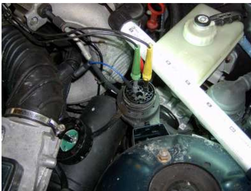
Obr. 4.8 – Umístění a zapojení diagnostické zástrčky BMW
