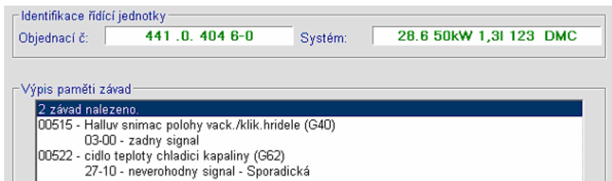
Obr. 4.17 – Výpis závad v řídicí jednotce motoru (Felicia)
