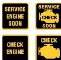
Obr. 2.3 – Varianty pro kontrolku poruchy MIL (OBD-II)
