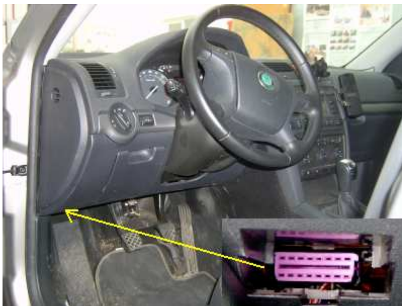
Obr. 4.19 – Umístění diagnostické zástrčky Škoda Octavia
