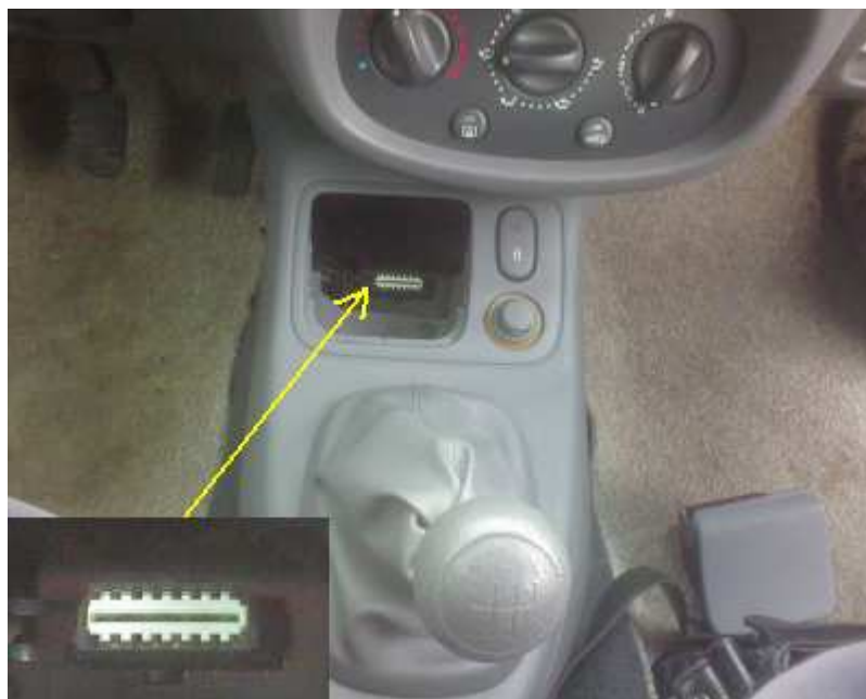
Obr. 4.4 – Umístění diagnostické zástrčky Renault Clio
