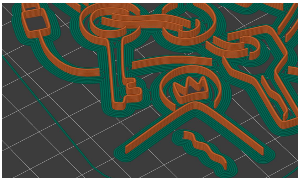
Obr. 28 Geometrická úprava raznice pro zrychlení tisku.
