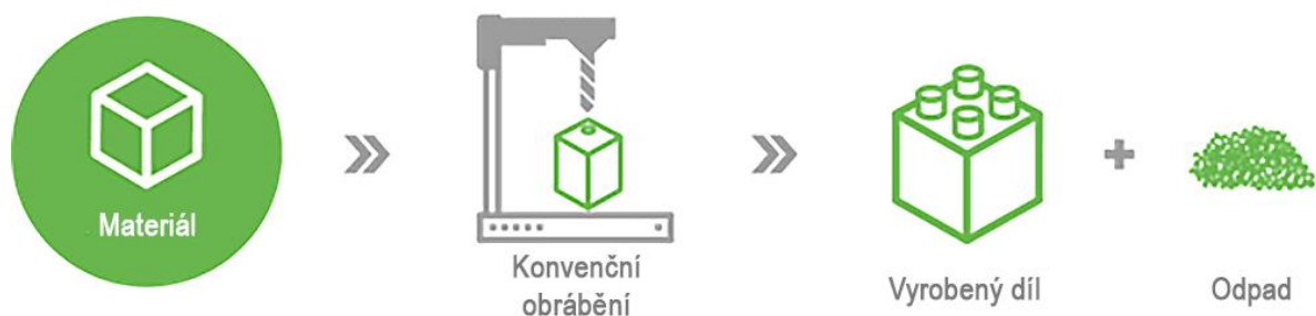
Obr. 2 Výroba konvenčním obráběním. [3]
