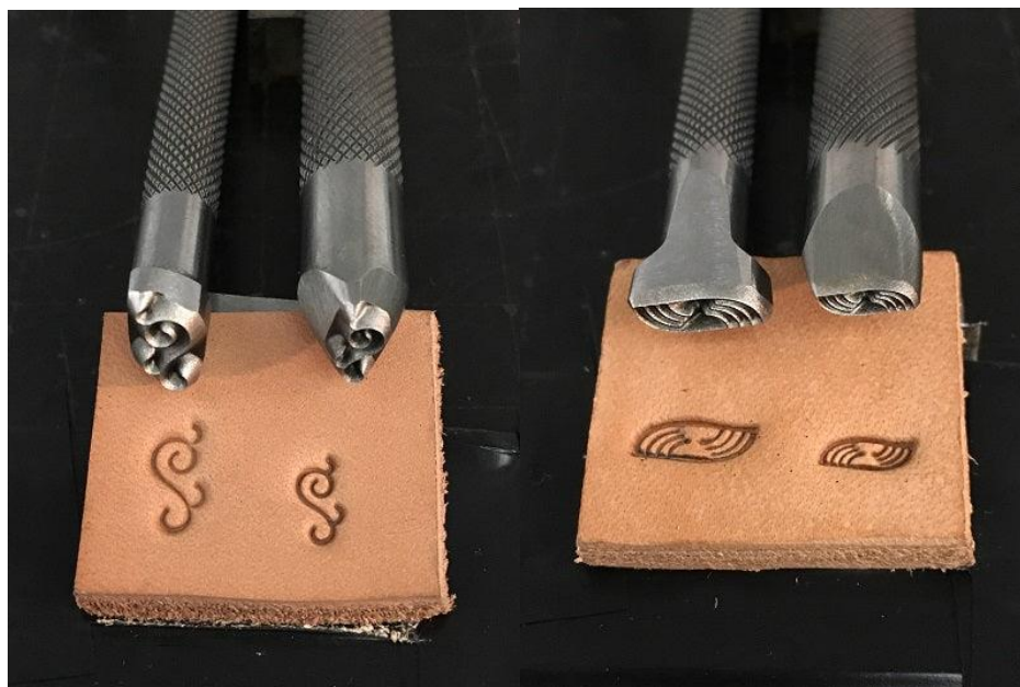
Obr. 14 Ukázka ražeb s využitím ocelových razidel. [32]
