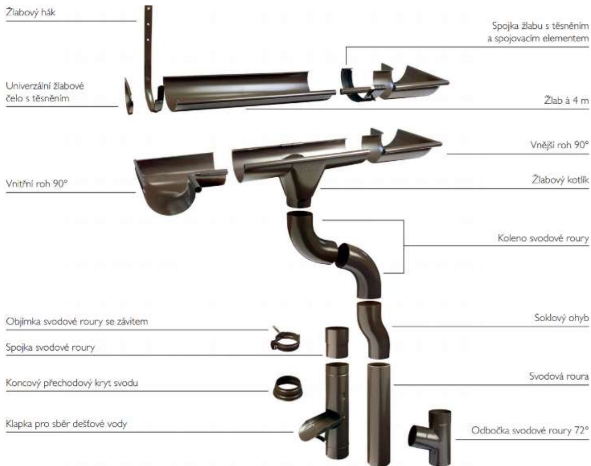
Obrázek 22 - Popis prvků systému StabiCor - M [1]
