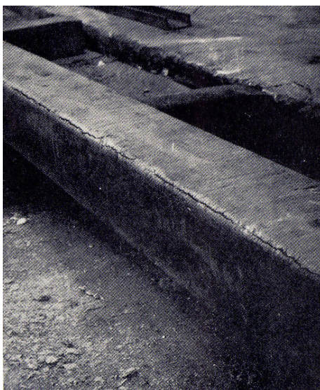
Obrázek 2.3: Podélná trhlinka v rohu předlitku způsobená chybným návrhem chladičské soustavy [5]
