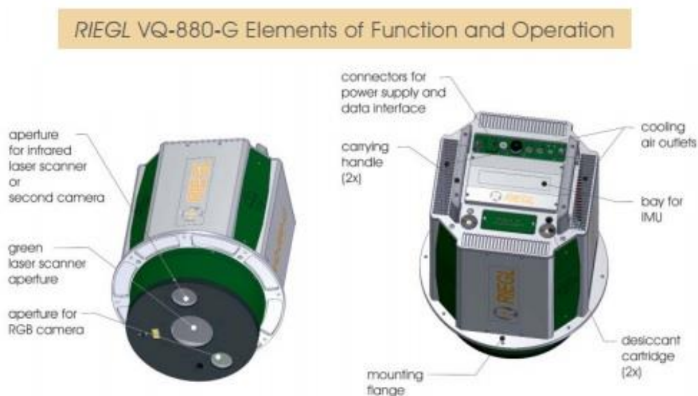
Obrázek 15. Hlavní funkční prvky skeneru Riegl VQ-880-G (Riegl, 2016).
