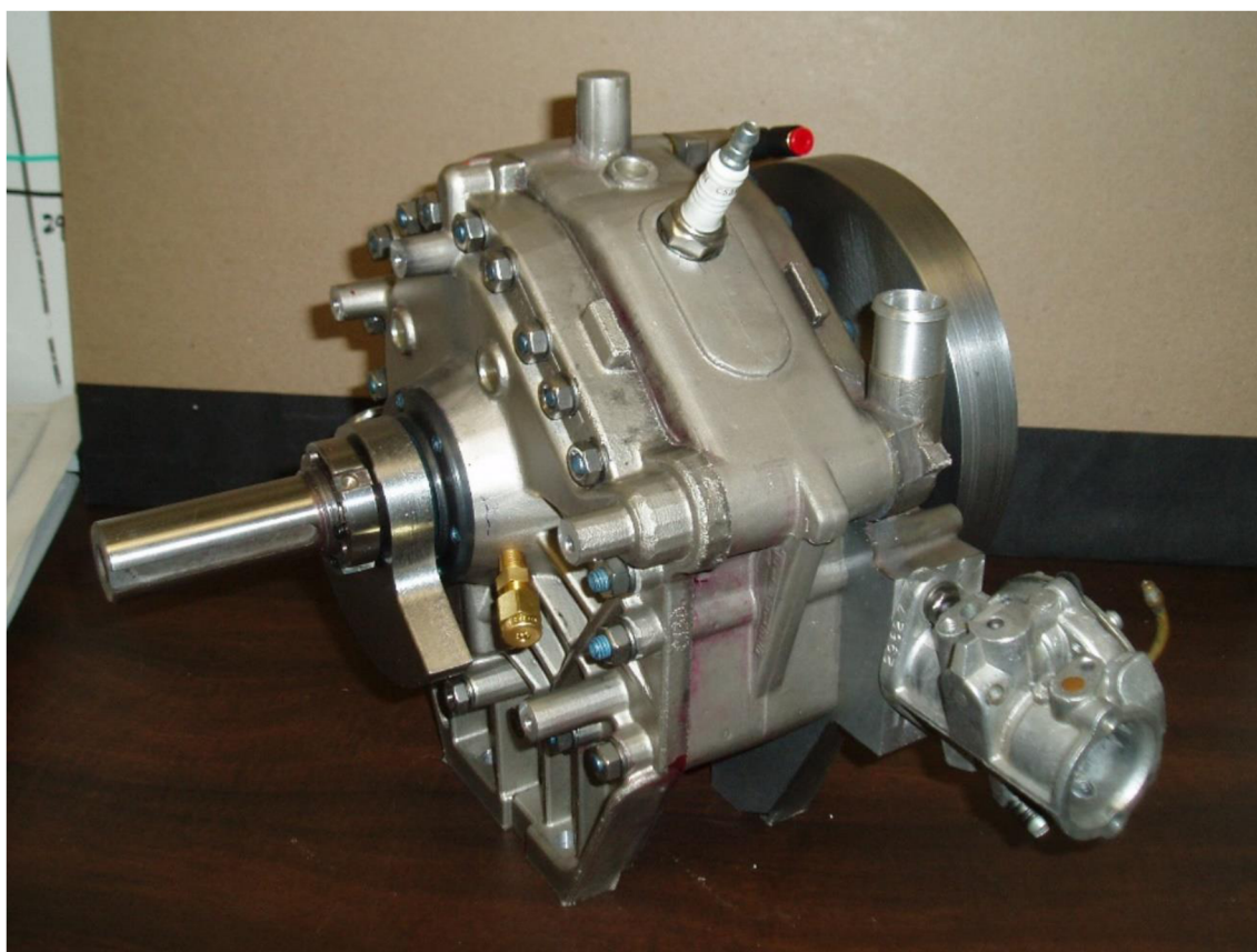
Obr. 3-6 Rotapower 150cc – Pohled na axiální sací kanál s karburátorovým systémem přípravy směsi [12]
