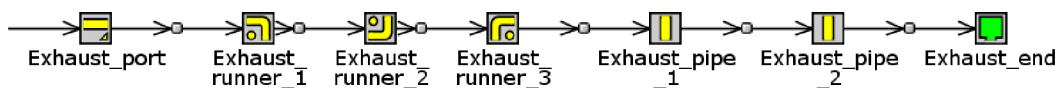
Obr. 15 Návrh termodynamického modelu výfuku – mezi prvky Exhaust_pipe_1 a Exhaust_pipe_2 je použita skoková změna průřezu potrubí, která způsobí propagaci rezonanční vlny ve výfukovém systému.
