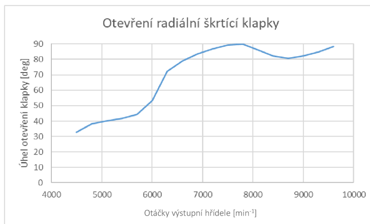
Graf 4-7 Otevření radiální škrťací klapky v závislosti na otáčkách motoru
