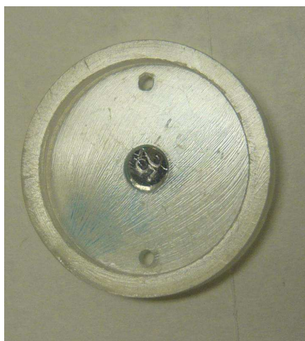
Obr. č. 12 Aktivační fólie (zde č. 25) uzavřená v pouzdře pro měření.
