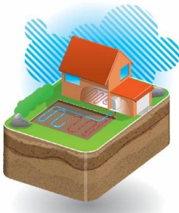
Obr. 4.11: Schéma systému tepelného čerpadla „Země–Voda“ čerpající tepelnou energii ze zemních plošných kolektorů.
