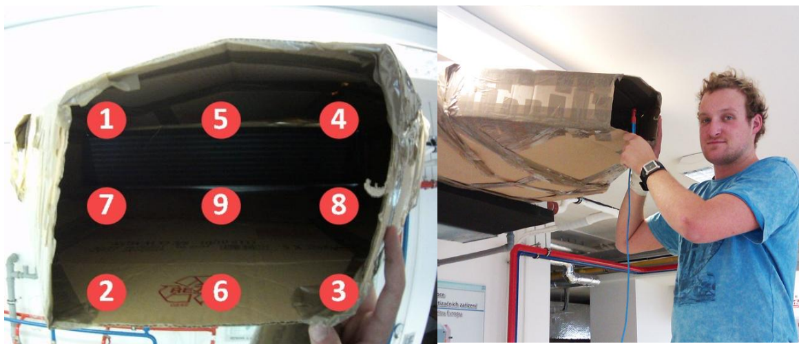
Obr. 10.8: Rozmístění měřících bodů (nalevo) a měření průtoku pomocí vrtulkového anemometru (vpravo)
