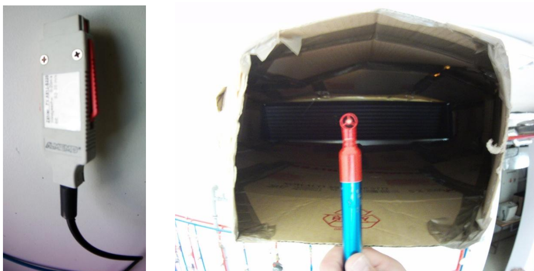
Obr. 9.3: Foto vrtulkového anemometru během měření rychlosti proudění vzduchu (vpravo) a ALMEMO konektor (nalevo)
