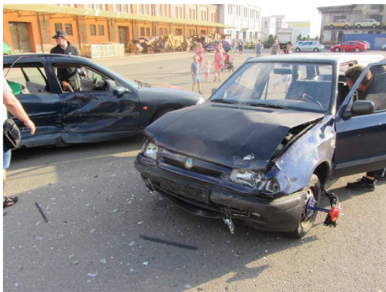
Obr. 36 Poškození vozidla Škoda Felicia [ÚSI, VUT v Brně]
