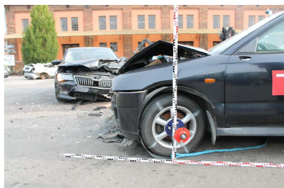
Obr. 27 Zkrácení přesahu vozidla Mitsubishi Carisma [ÚSI, VUT v Brně]
