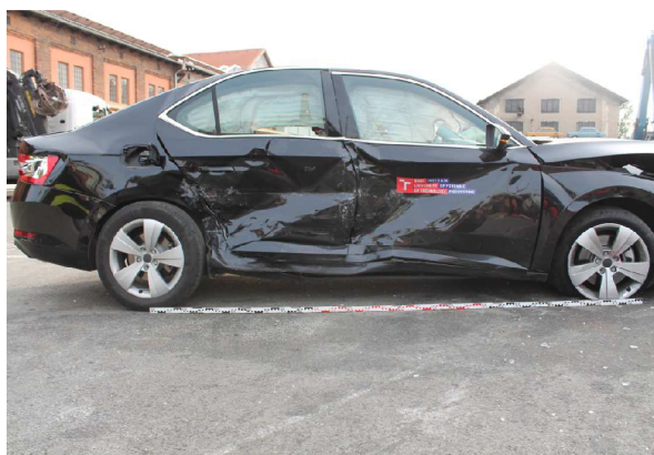
Obr. 28 Pohled na celkové poškození vozidla Škoda Superb III [ÚSI, VUT v Brně]
