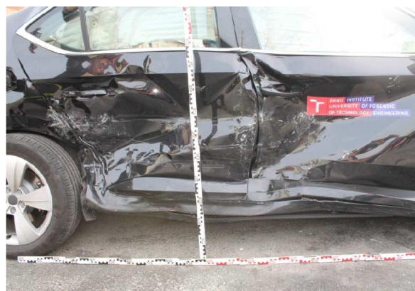
Obr. 29 Detail poškození zadních pravých dveří [ÚSI, VUT v Brně]
