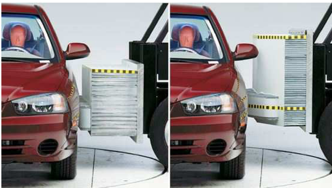
Obr. 6 Rozdíl výšky bariéry dle IIHS(vpravo) a dle NHTSA (vlevo) [11]
