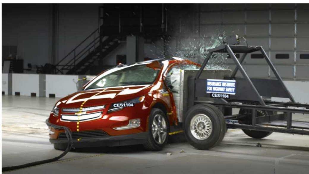
Obr. 5 Boční náraz vozidla pomocí pohyblivé bariéry dle NHTSA [17]
