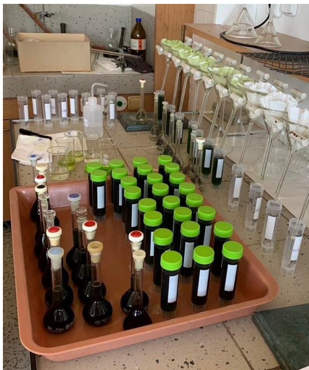
Obrázek 10: Filtrace vzorků na filtrační aparatuře
