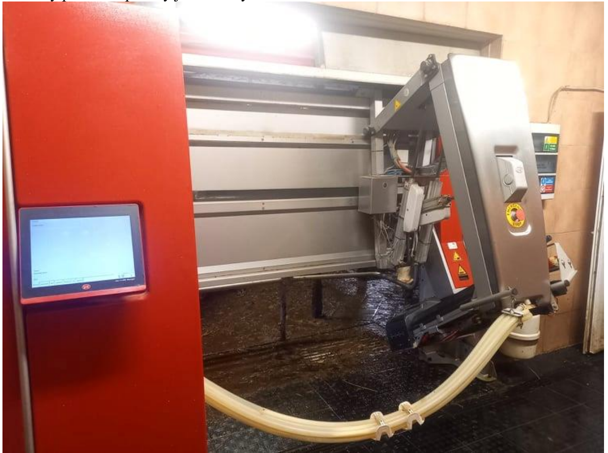
Příloha 1. Pohled na vnitřní prostor dojícího robota a operační prostor pro obsluhu.
