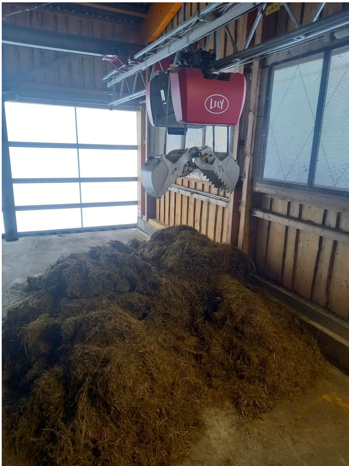
Příloha 4. AFS – podavač krmiva nabírající objemná krmiva z uložště krmiva.
