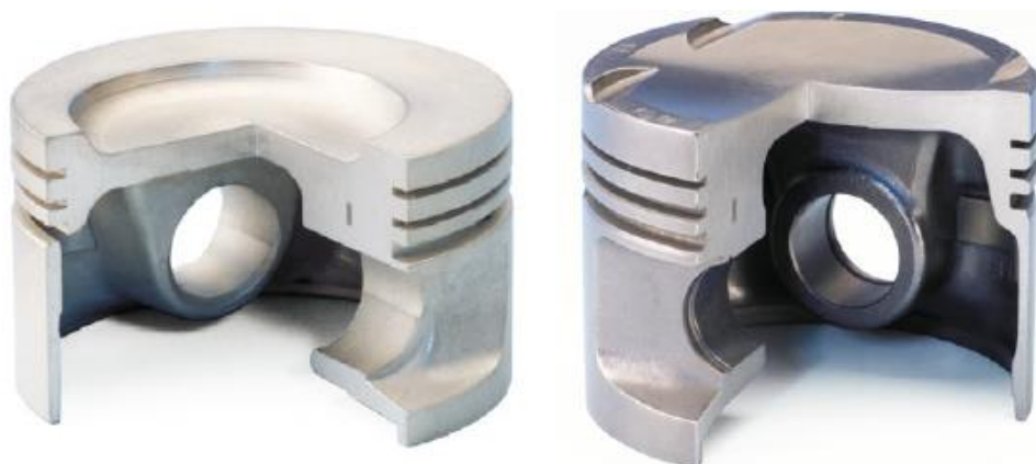
Obr. 8 Piesty typu Autothermik (vľavo) a Autothermatik [1]
