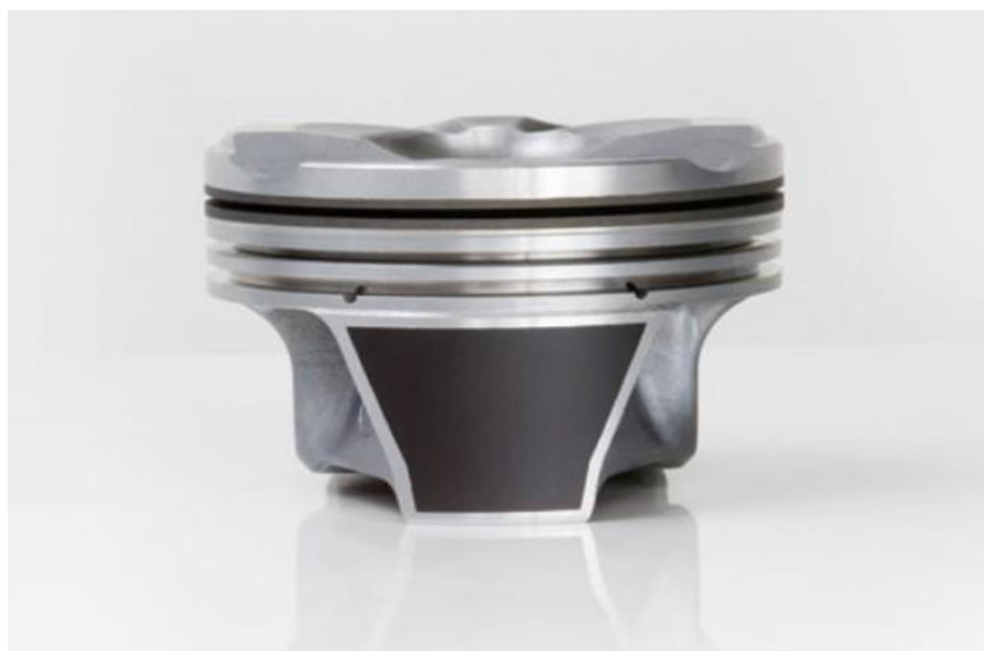
Obr. 12 Piest MAHLE Evolite s nosičom krúžkov v prvej drážke [23]
