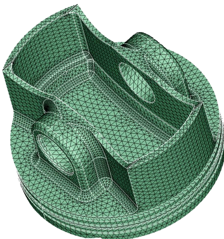
Obr. 26 Siet'ovanie modelu piestu v prostredí Altair SimLab 2017
