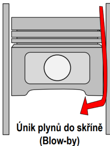
Obr. 7 Únik plynů mezi vložkou valca a piestnymi krúžkami [12]
