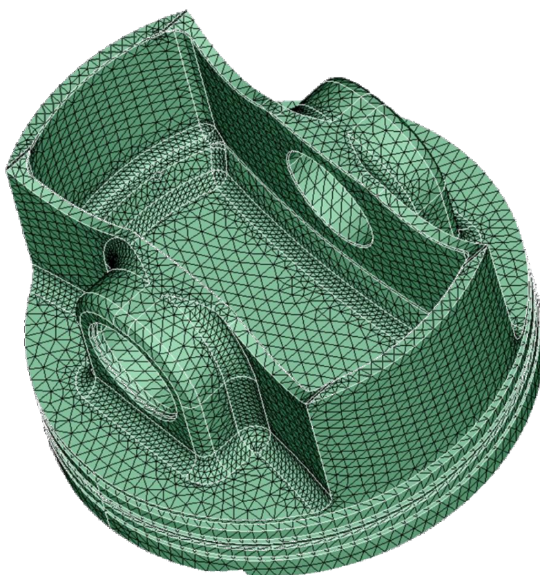
Obr. 26 Sietovanie modelu piestu v prostredí Altair SimLab 2017
