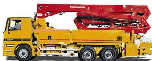
Obr. E.29 Autočerpadlo PUTZMEISTER M31-5, zdroj: [56, 57]
