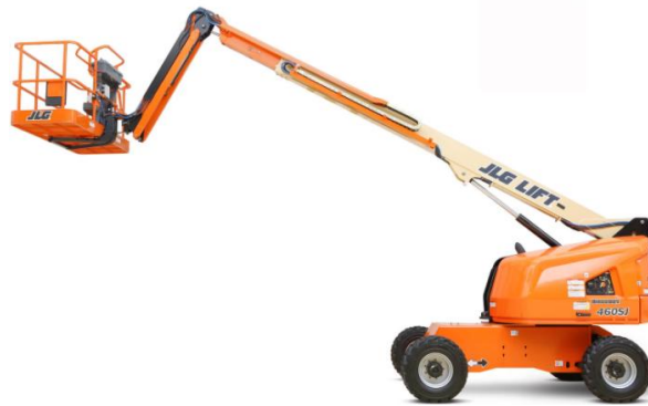
Obr. E.35 Teleskopická vysokozdvíhací plošina JLG 450 SJ Reaching Out, zdroj: [28]
