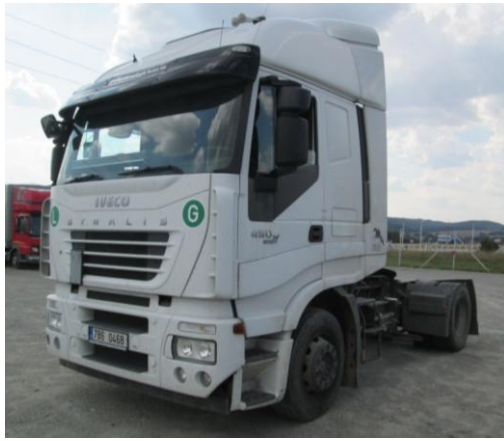
Obr. E.27 Jízdní souprava - tahač IVECO Starlis 440S45T 4x2 + valník Schmitz Cargobull S01, zdroj: [21,22]
