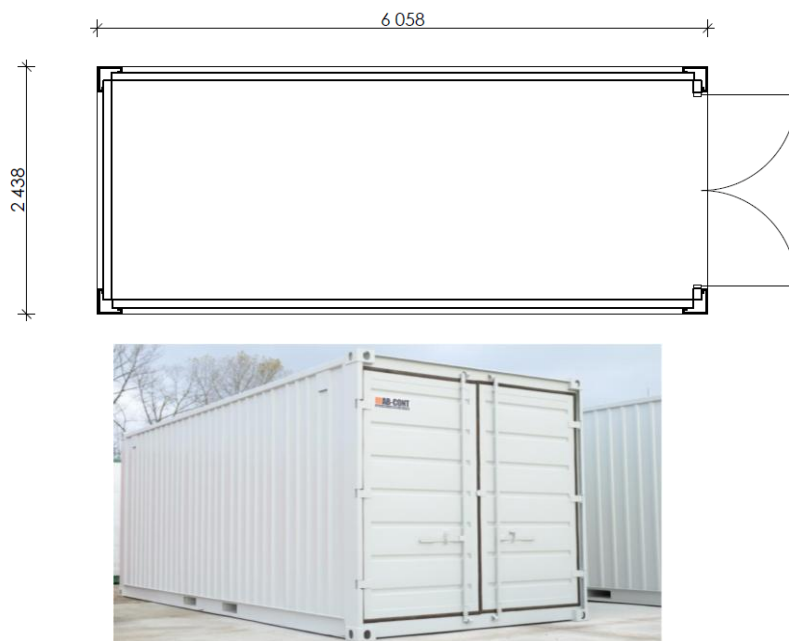
Obr. F.3 Skladový kontejner AB-CONT SK 20, zdroj: [48]
