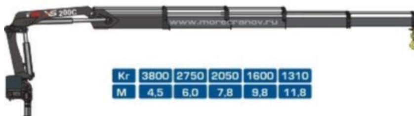
Obr. E.28 Nákladní automobil MAN 26.414 s hydr. rukou HIAB 200 C-4, zdroj: [18,19]
