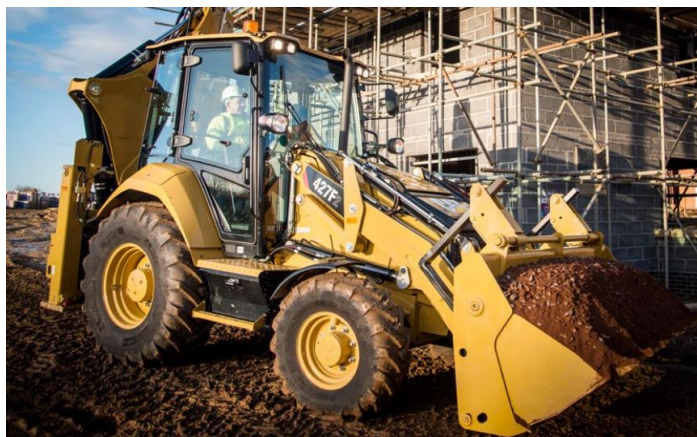
Obr. E.22 Rýpadlo-nakladač CATERPILLAR 427F2, zdroj: [14]
