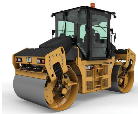
Obr. E.25 Tandemový vibrační válec CATERPILLAR CD10, zdroj: [14, 60]
