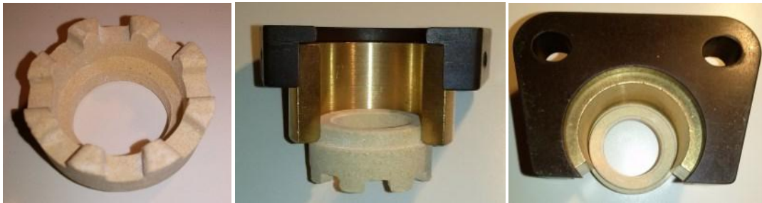
Obr. D.10 Keramický kroužek a jeho osazení, zdroj: [39]
