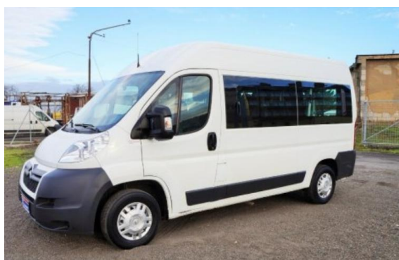
Obr. E.34 Dodávkový vůz Citroën Jumper 2.2HDI/96kw L2H2, zdroj: [26]
