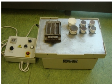
Obr. 14 – Vibrační stolek VSB-40 REM
