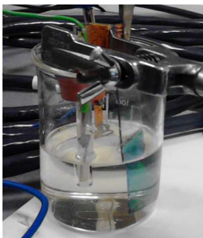
Obr. 7.6: Interkalace iontů \text{Li}^+ do aktivní vrstvy
