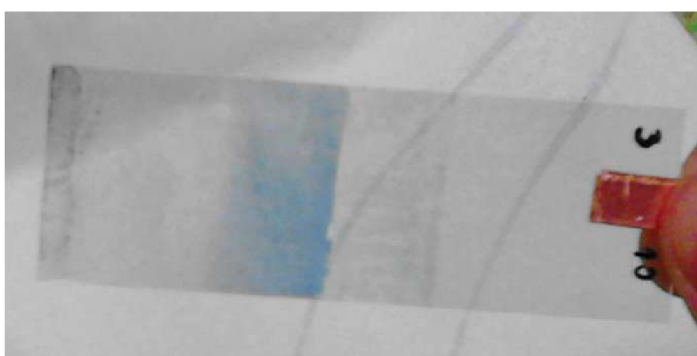
Obr. 7.8: Částečně odbarvená aktivní elektrochromní vrstva
