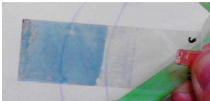
Obr. 7.7: Zabarvení aktivní vrstvy u vzorku 3 neočištěného vodou
