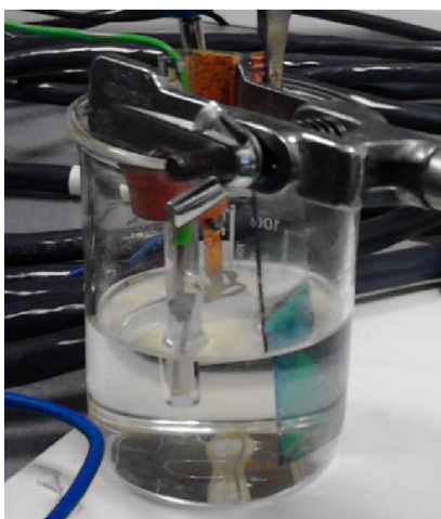
Obr. 7.6: Interkalace iontů Li + do aktivní vrstvy
