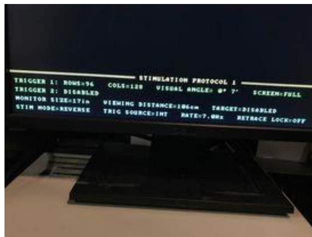
Obr. č. 16: Ukázka nastavení přístroje. Monitor ve vzdálenosti 106 cm od pozorovatele. Používaná stimulace 7 Hz. Konkrétně počet řádků 96 a počet sloupců 128, při daném nastavení je dosaženo úhlové velikosti stimulačních prvků 7' .
