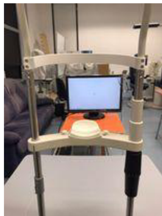
Obr. č. 11: Fotografie využitého monitoru ve vzdálenosti 120 cm od oka probanda, proband fixoval hlavu v hlavové opěrce, červené fixační světlo na pravém okraji monitoru.
