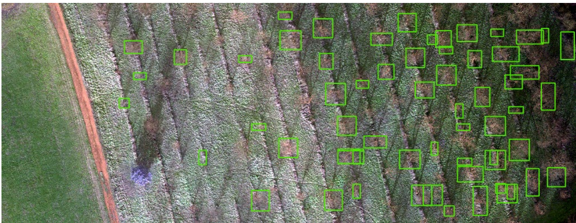
Obr. 44 Výsledky objektové detekce stromů pomocí modelu RetinaNet s nastavením 20 epoch – po vyčištění
