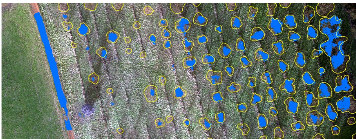
Obr. 40 Výsledky per pixel klasifikace pomocí modelu s typem U-Net (modrá barva) při porovnání s manuálně zakreslenými stromy (polygony se žlutým obrysem)
