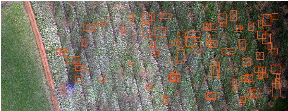
Obr. 46 Výsledky objektové detekce stromů pomocí modelu RetinaNet s nastavením 100 epoch
