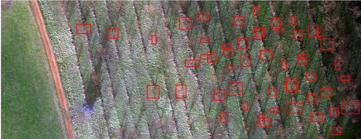
Obr. 45 Výsledky objektové detekce stromů pomocí modelu RetinaNet s nastavením 30 epoch
