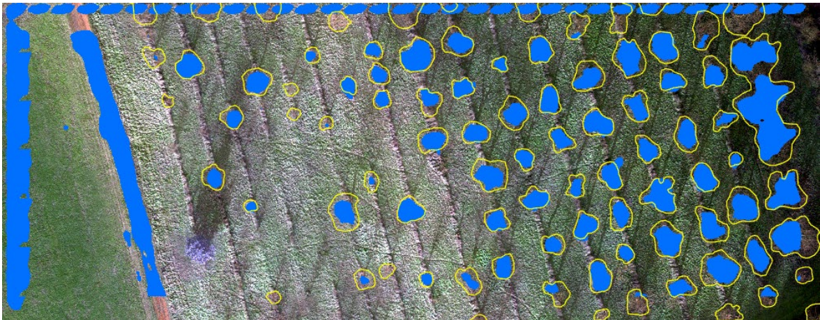
Obr. 43 Výsledky per pixel klasifikace pomocí modelu s typem PSPNet (modrá barva) při porovnání s manuálně zakreslenými stromy (polygony se žlutým obrysem)
