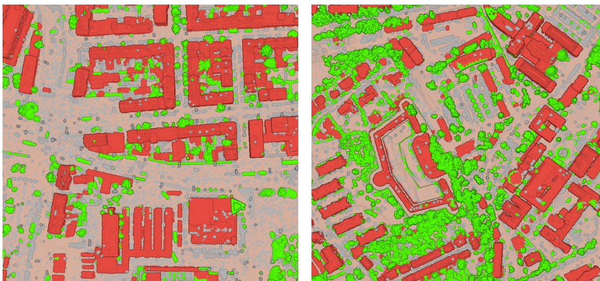
Obr. 47 Výsledky klasifikace dat LIDAR v programu ArcGIS Pro – průmyslová oblast (vlevo), a obytná zástavba (vpravo)
