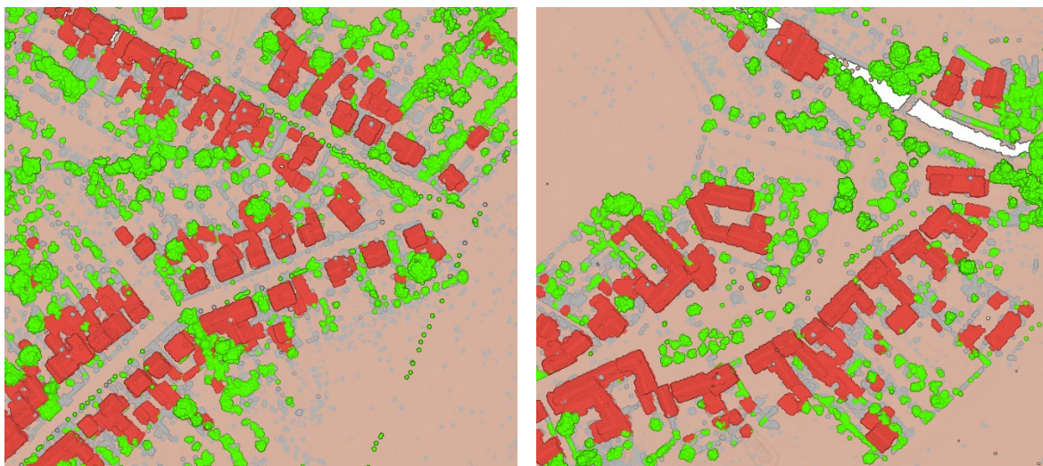
Obr. 49 Výsledky klasifikace dat LIDAR v programu ArcGIS Pro – Střeň (vlevo), Březové (vpravo)
