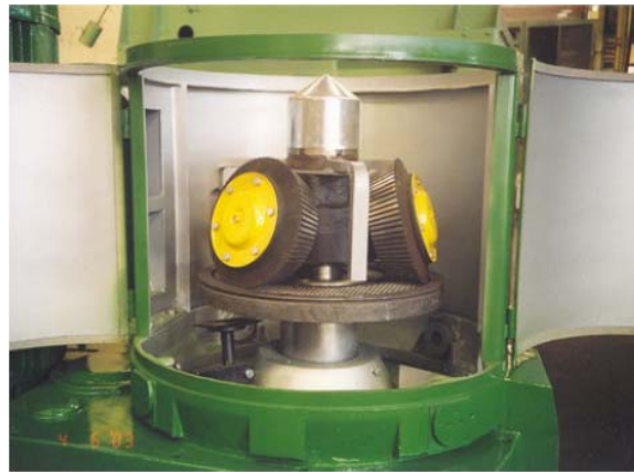
Obr. 6: Peletovací lis na drcené stébelniny a piliny TL 700 (Andert, Sladký, Abraham, 2006)
