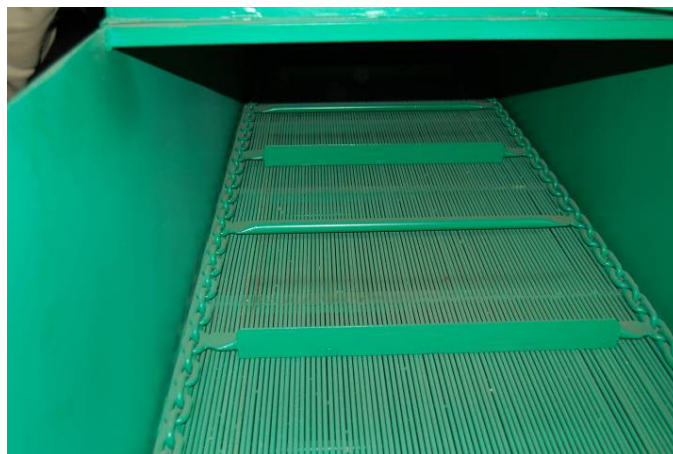
Vnitřek chladiče se zpětným dopravníkem odrolu
