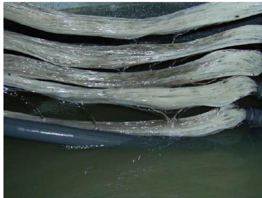
Obr. 7.2 Čištění svazků vláken praním [22]
