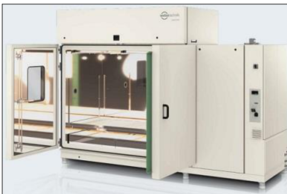
Obr. 3.5 Solární klimatická skříň SUN 3600 Vötsch [84]
