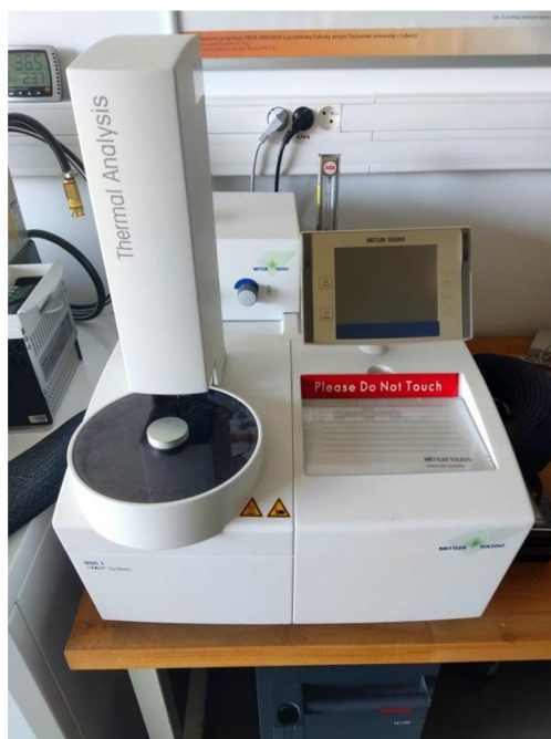
Obr. 3.12 Diferenční snímací kalorimetr Mettler Toledo DSC 1
