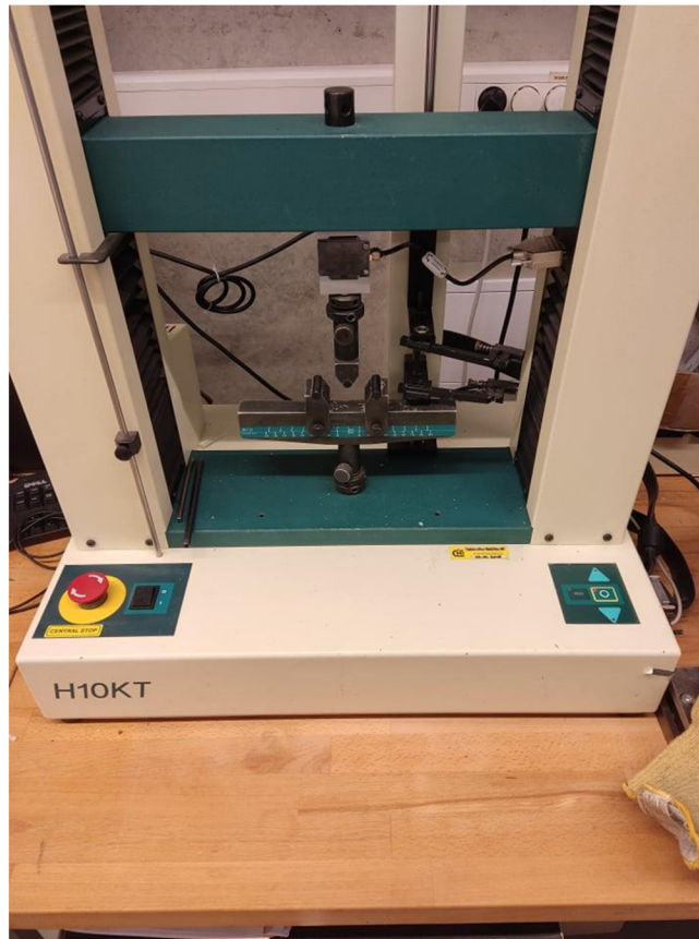
Obr. 3.26 Zařízení pro zkoušku ohybem Hounsfield H10KT
