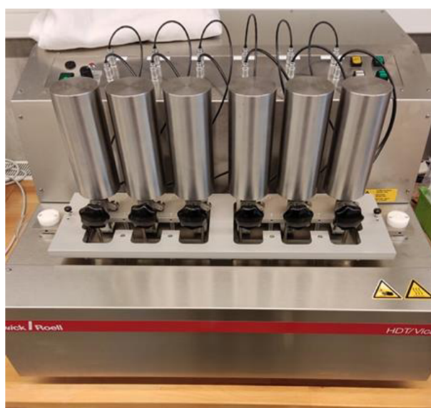
Obr. 3.11 Zařízení HDT/Vicat A se zatíženými vzorky ponořenými v olejové lázni
