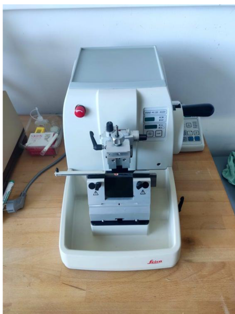
Obr. 3.9 Rotační mikrotom Leica RM 2255
