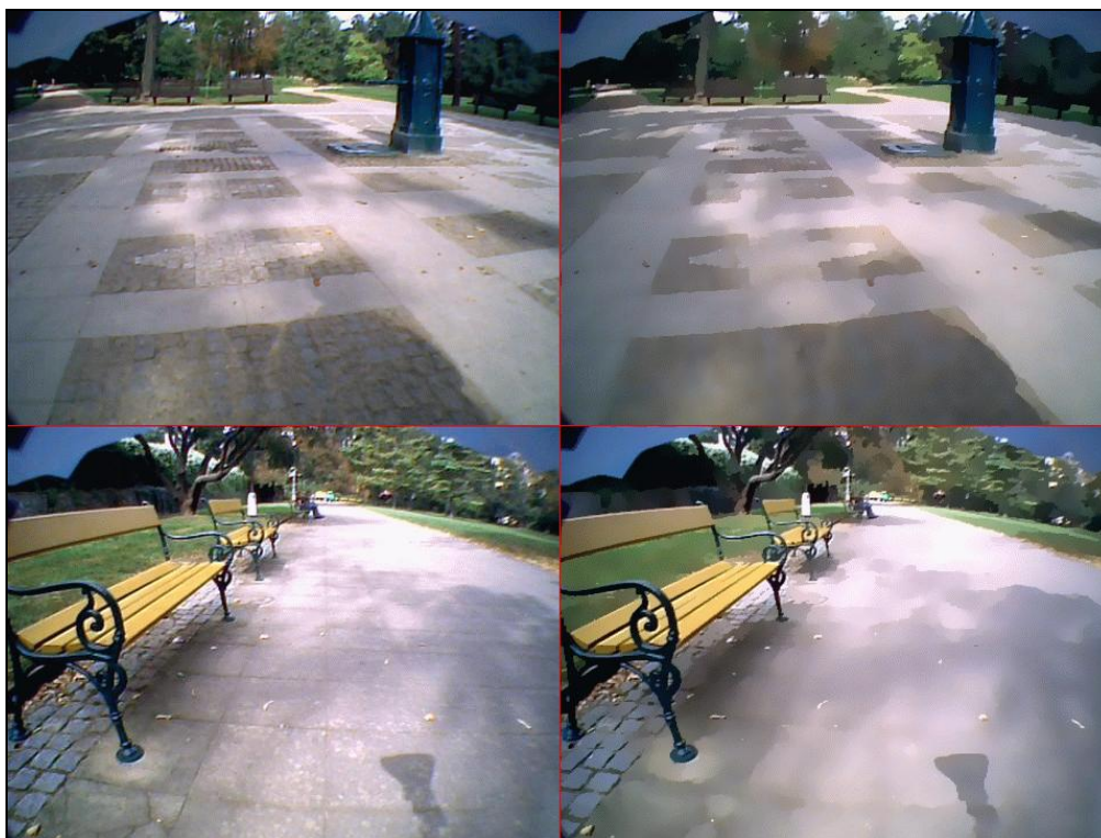
Obr. 13. Příklad filtrace algoritmem Mean-Shift. Vpravo původní obraz, vlevo filtrovaný obraz s použitými hodnotami h_s = 10 a h_r = 8 .
