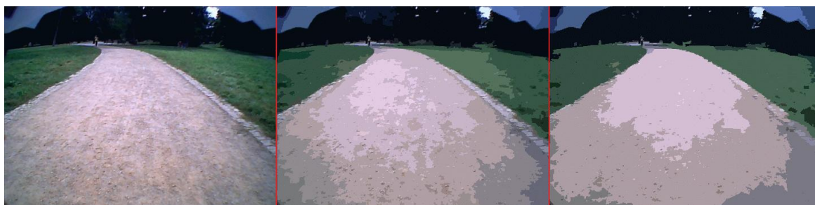
Obr. 9. Příklad segmentace obrazu metodou růstu regionů v RGB barevném prostoru. Vlevo je původní obraz, uprostřed je segmentovaný obraz pro prahovou hodnotu t_{min} = 30 a vpravo je segmentovaný obraz pro prahovou hodnotu t_{min} = 50 .
