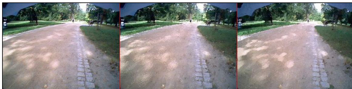
Obr. 12. Příklad segmentace algoritmem Mean-Shift. Vpravo je původní obraz, vprostřed je segmentovaný obraz s hodnotami h_s = 3 a h_r = 40 , vlevo je obraz segmentovaný s hodnotami h_s = 6 a h_r = 25 . Pro oba obrazy bylo použito \varepsilon = 0,02 . Zpracované obrazy obsahují barevné hodnoty bodů, do kterých algoritmus z dané pozice zkonvergoval.
