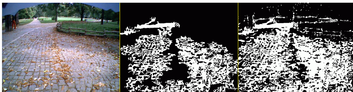
Obr. 18. Porovnání segmentačních metod rostoucích regionů a prahování. Obrázek vlevo zobrazuje cestu s navátým listím, prostřední obrázek je výsledek segmentace rostoucích regionů a obrázek vpravo je výsledek segmentace prahováním.
