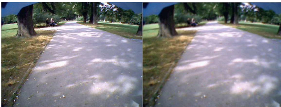
Obr. 5. Příklad konvoluce gaussovým jádrem. Vlevo je originální obraz a vpravo je zpracovaný obraz konvolucí gaussovým jádrem o rozměru 9x9.
