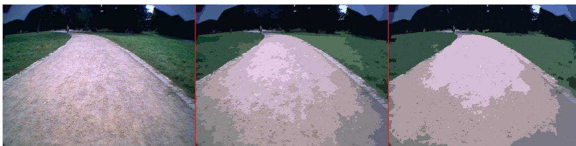
Obr. 9. Příklad segmentace obrazu metodou růstu regionů v RGB barevném prostoru. Vlevo je původní obraz, uprostřed je segmentovaný obraz pro prahovou hodnotu t_{min} = 30 a vpravo je segmentovaný obraz pro prahovou hodnotu t_{min} = 50 .
