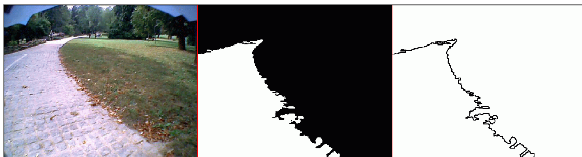
Obr. 16. Ukázka získání hranice segmentovaného objektu. Vlevo je původní obrázek, uprostřed segmentovaný objekt po odstranění malých oblastí, vpravo hranice objektu.
