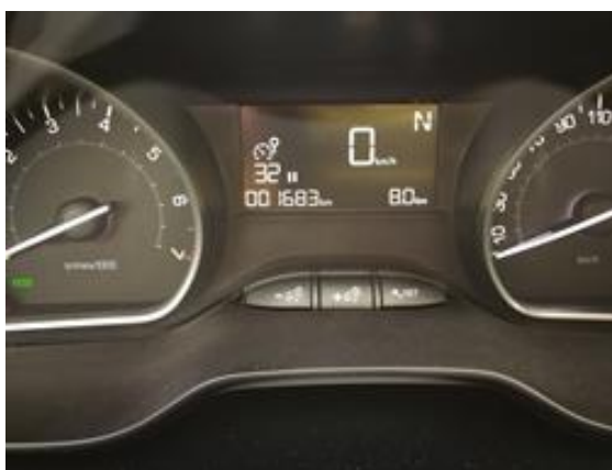
Obrázek 15: Signalizace jízdního režimu „N“ na panelu přístrojů
