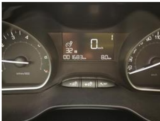
Obrázek 17: Signalizace jízdního režimu „M“ na panelu přístrojů
