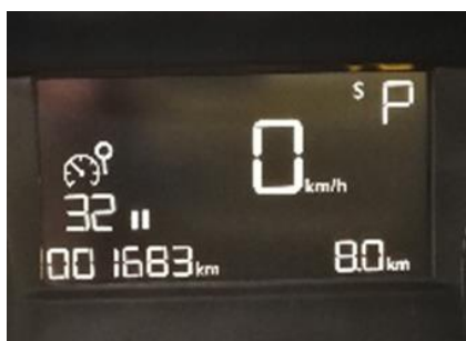
Obrázek 21: Signalizace aktivované funkce „S“ na panelu přístrojů
