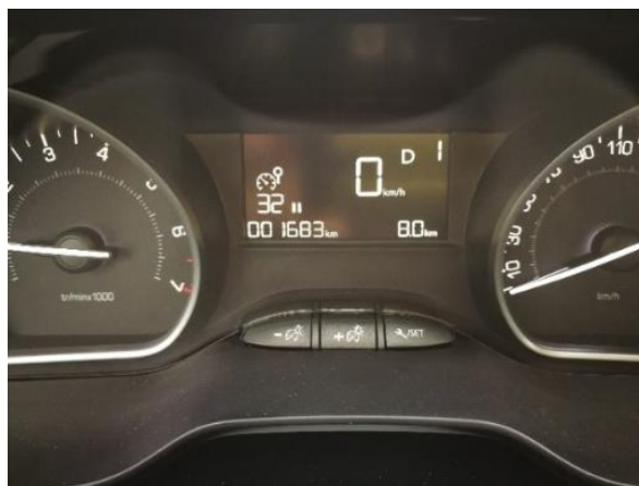
Obrázek 16: Signalizace jízdního režimu „D“ na panelu přístrojů
