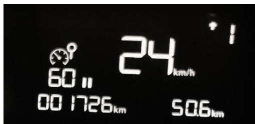
Obrázek 18: Signalizace doporučení o přerazení na vyšší rychlostní stupeň
