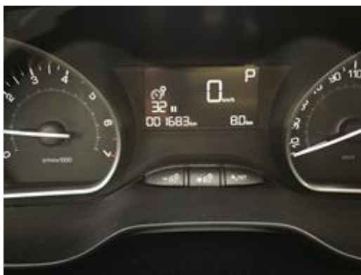
Obrázek 13: Signalizace jízdního režimu „P“ na panelu přístrojů
