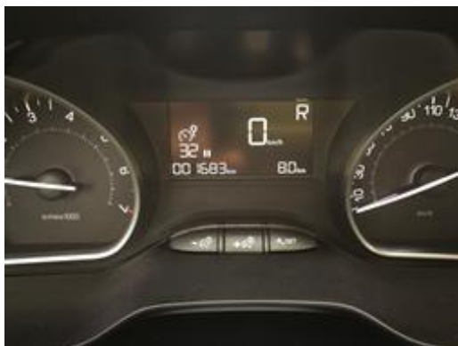
Obrázek 14: Signalizace jízdního režimu „R“ na panelu přístrojů
