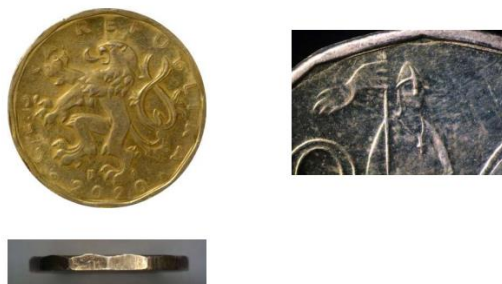
Obrázek č. 39 – Pravá dvacetikoruna a její padělek pod mikroskopem
