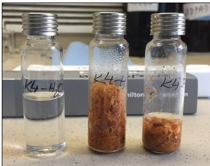
Obrázek 29: Fotografie z přípravy kalibrace 3 typů matric, zleva: voda, hobliny, piliny
